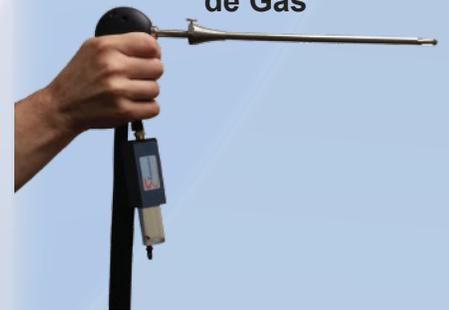
La unidad de acondicionamiento de gas está situado a la salida de la sonda de muestreo. En esta ubicación, la agua excesiva en los gases de combustión condensa rápidamente y separa del muestreo de gas. Este procedimiento minimiza contacto de los gases con la condensación que puede afectar la precisión de las mediciones de NO<sub>x</sub> y SO<sub>2</sub>.
